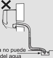
● Inclíne ligeramente la manguera de drenaje hacia abajo. La manguera de drenaje no puede ser curvada, elevada ni fluctuante, etc.
